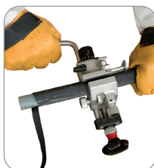
Inciser et enlever le semi-conducteur pelable
