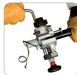
Usiner le semi-conducteur non pelable
