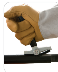
Usiner le semi-conducteur non pelable
