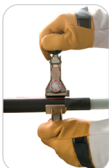
Inciser et enlever le semi-conducteur pelable
