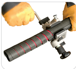
Enlever la protection mécanique
